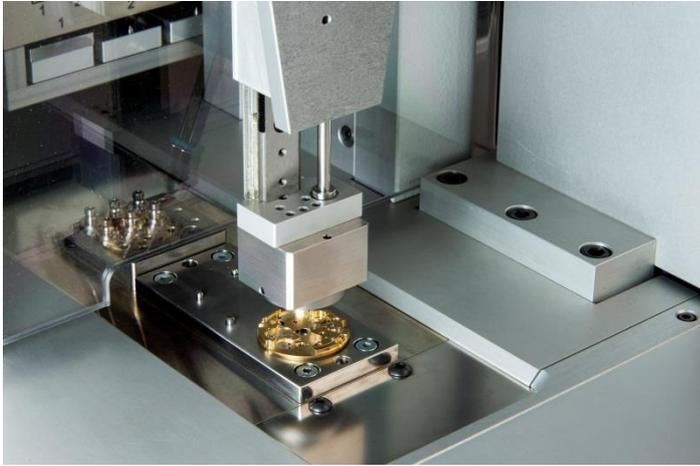
Le système de palettisation permet de charger et de décharger automatiquement les ébauches et de les stocker de façon intelligente en fonction des résultats de chassage.
